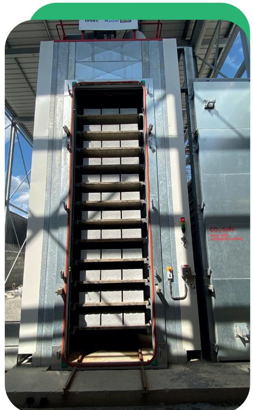
Unsere CO<sub>2</sub>-Kammer ist das schlagende Herz unserer Carbstone-Produktion. Hier werden die Blöcke mit CO<sub>2</sub> gebunden und anschließend ausgehärtet. Nach 24 Stunden - je nach Größe - sind sie bereit für die Weiterverarbeitung.
